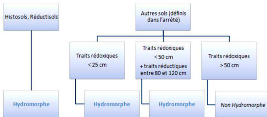
Figure 37. Principe de détermination d'un sol hydromorphe de zone humide selon la réglementation.
